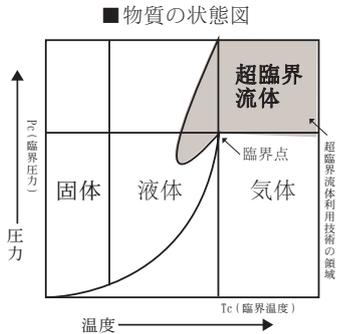
い、この点を超える状態を「超臨界流体」の状態といいます。「超臨界流体」の状態は、気体と液体の両方の性質を持っていて、プロポリス原塊や植物などの天然成分を溶かし出す強い力があります。そして、含有成分を溶かし出した後に圧力を下げると、二酸化炭素は普通の気体に戻って全て揮発してしまい、純粋な抽出物だけが残ります。この原理を精油の抽出に応用した方法が「超臨界流体抽出法」と呼ばれています。
